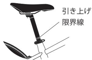
シートポストの引き上げ限界線が見えない高さである事を確認してください。
